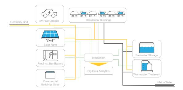
FIGURE 4 - A VIABILITY OF BLOCKCHAIN DEPLOYMENT IN LOCAL MICROGRID
